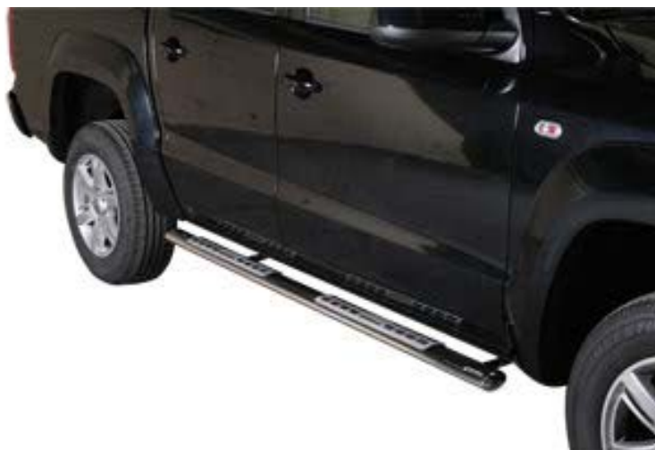
Schwellerrohr oval mit Alu Auflagen Ø 100 x 40mm, Edelstahl DSP/280/IX Amarok DK
